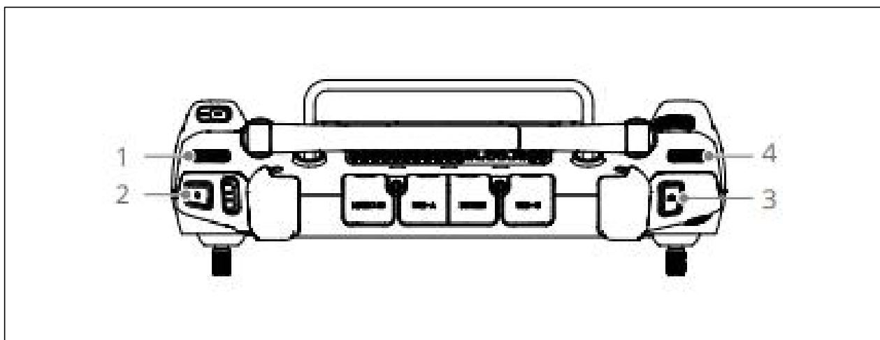
按下遥控器右侧拍照键(3)，将拍摄一张照片，并存储到TF卡中。
